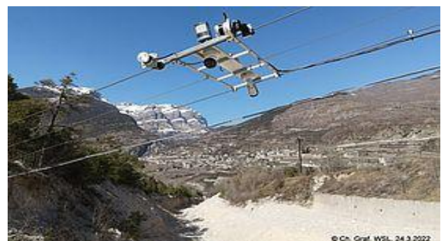
Figuur 10. Bijgeplaatste LiDAR sensoren boven Illgraben. (© Eidg. Forschungsanstalt WSL, Copyright 2024)
